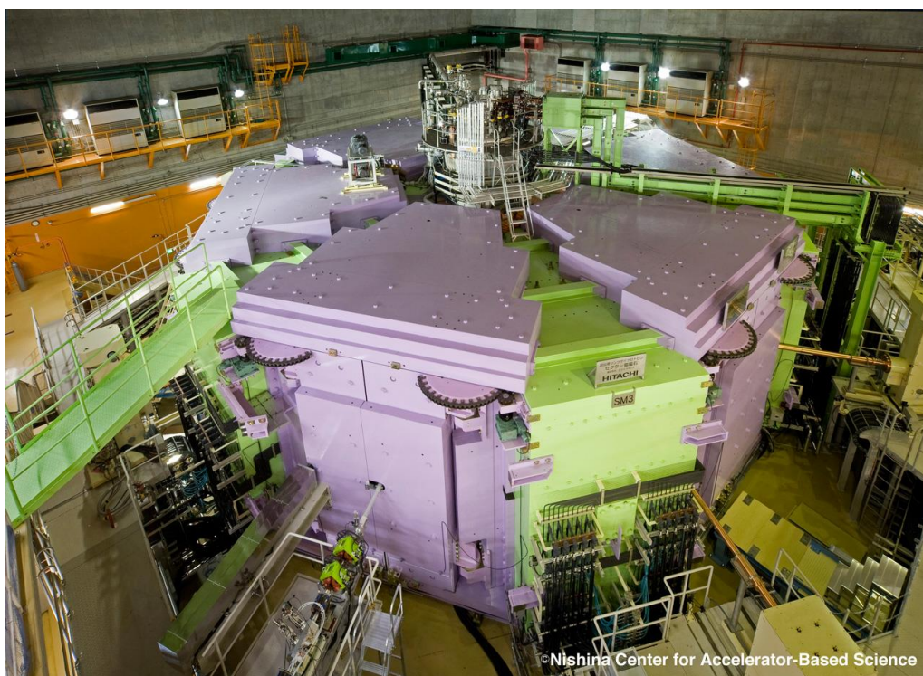
図2 超伝導リングサイクロトロン（理化学研究所提供）
